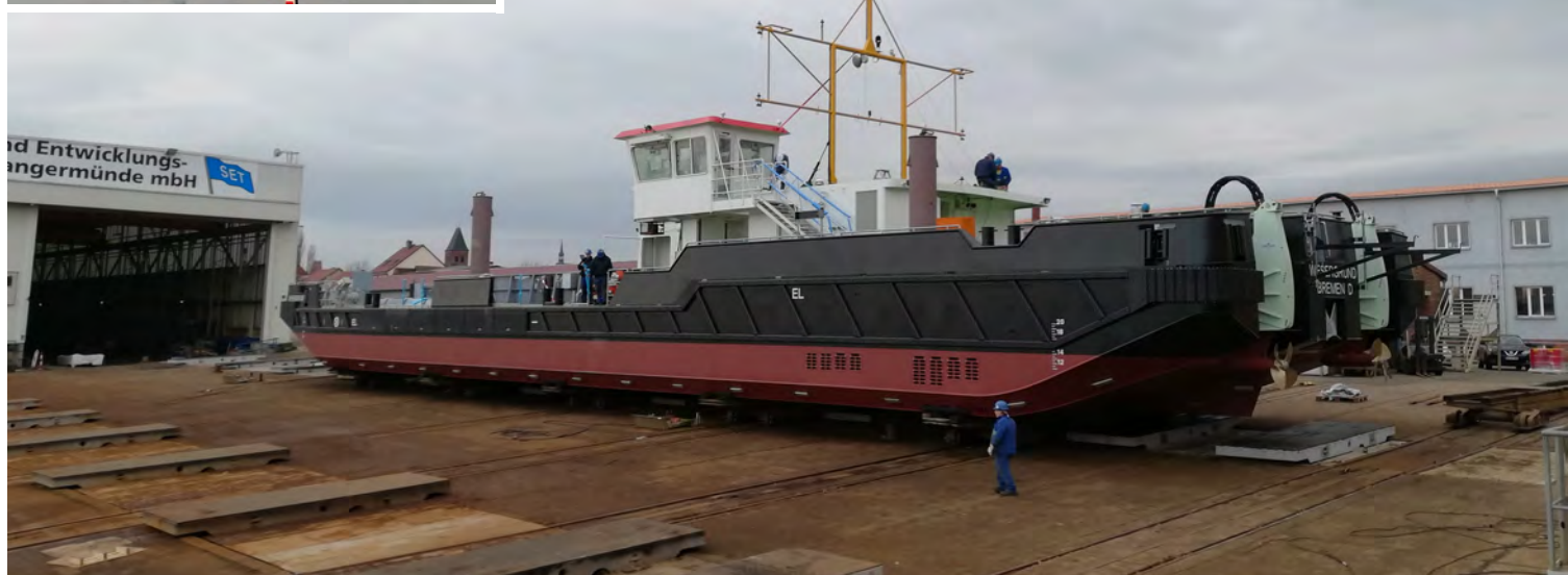
Die künftige »Wesergrund« wurde bei SET aus der Schiffbau-Halle gefahren, abgeslipt und anschließend an die Ausrüstungspier verholt
